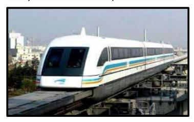
En los trenes de levitación: Japón retorna la carrera de los trenes de alta velocidad con un tren de levitación magnética, es decir un "Maglev", abreviación de Magnetic levitación. Esto significa que este tipo de trenes flotan gracias a los imanes permanentes remplazando el hierro utilizado anteriormente en las vías.
